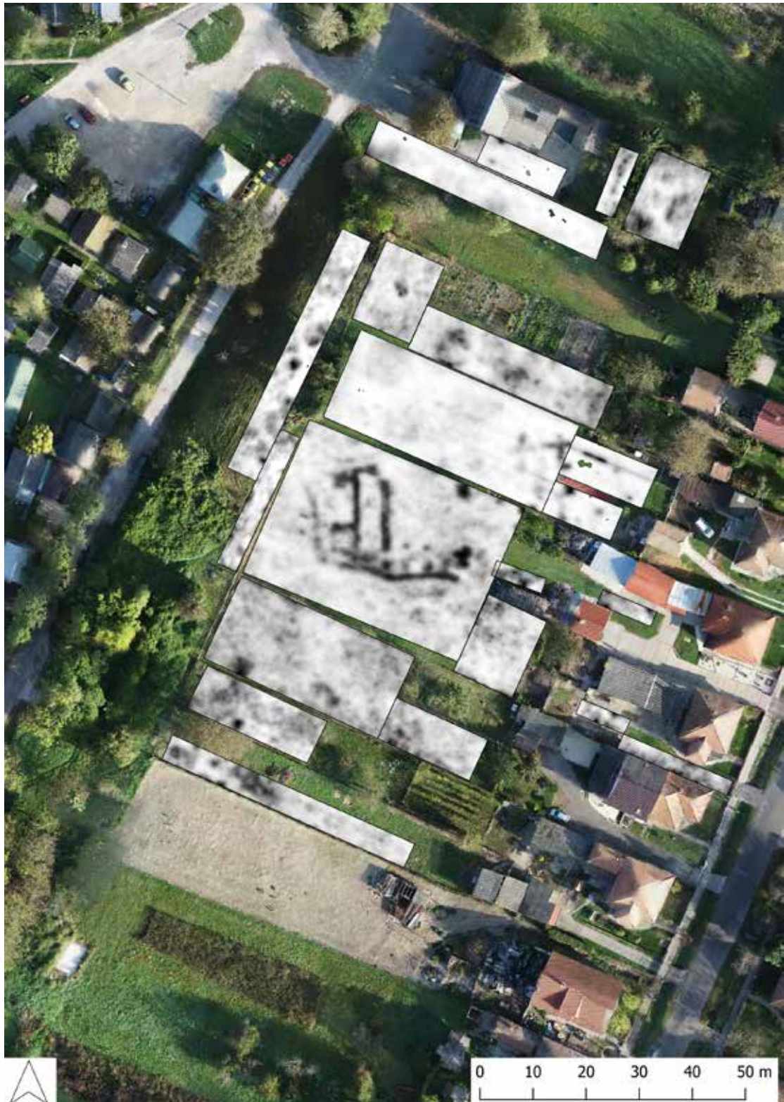
7. ábra. A talajradarral felmért területek amplitúdótérképe -80–100 cm közötti mélységben.
